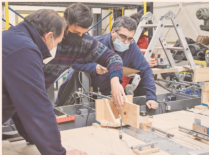
Ensayo estructural de resistencia sísmica de edificio de tres pisos en madera proporción 1:2
